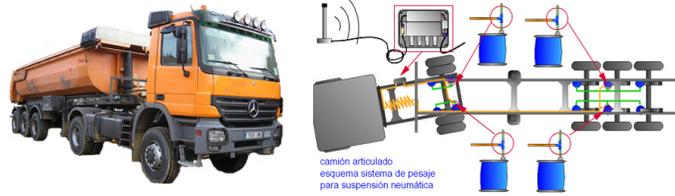
La báscula de abordó PIKAM es la única en el mercado que incorpora cuatro sensores de medida independientes, midiendo sobre los ejes delanteros y traseros los circuitos neumáticos derecho e izquierdo de manera independiente. Esta técnica de medida combinada con electrónicas de muy alta precisión la convierte en la báscula de abordó mas fiable, estable y precisa del mercado.
