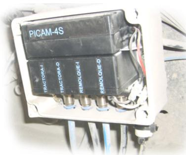
La centralita de sensores con radiocomunicación tiene estructura de doble caja, lo que nos permite ubicarla en cualquier punto de chasis.
